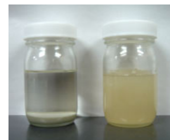
トルエンへの分散比較 左：通常品 右：親有機化学品
