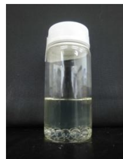
スメクトン-STN 溶媒：NMP
